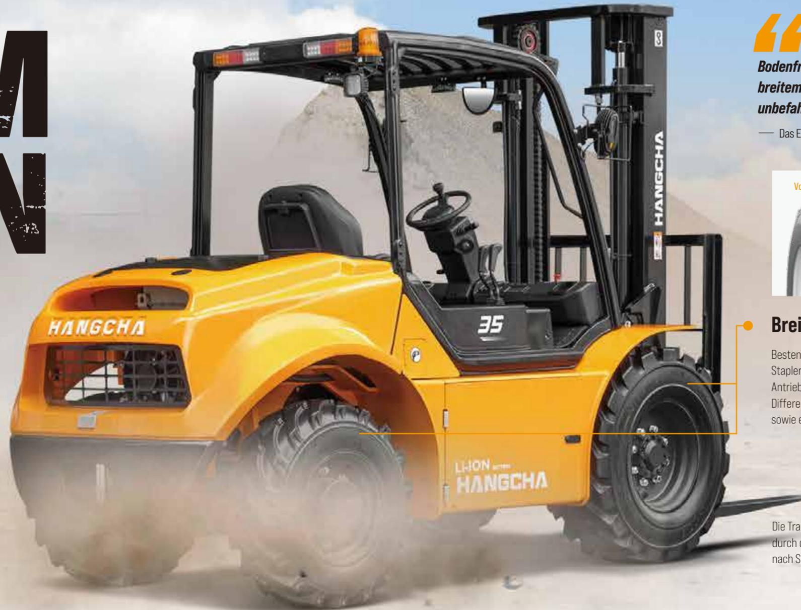
“ Ein großer Überhangwinkel, große Bodenfreiheit und schlauchlose Reifen mit breitem Profil – so bleibt kaum ein Gelände unbefahrbar! ”
