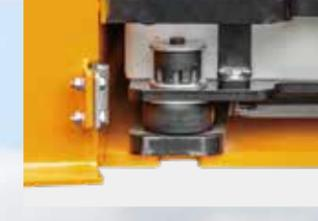
Jedes Produkt dieser Serie ist mit CATL Lithiumbatterie ausgestattet; gegen Aufpreis ist ein Feuerlöscher erhältlich. Die Batterie ist eingehängt in einer stoßdämpfenden Halterung.
