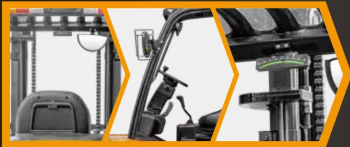
Das Hubgerüst mit breitem Blickwinkel ist so orientiert, dass die Sicht möglichst wenig behindert wird. Auch das Konzept der Seitenflächen wirkt in diesem Sinn.
